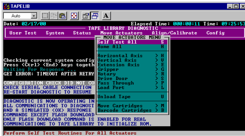
Figure 6-7. Move actuators menu ( Menu Déplacer le mécanisme de positionnement)
