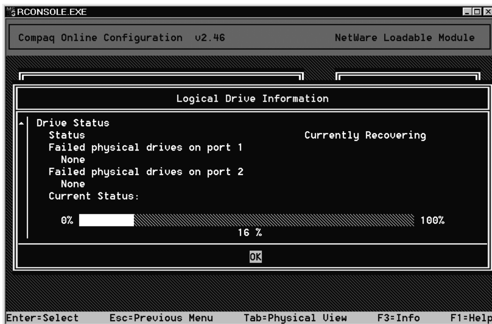
Figura 5-32. Reconstrucción de unidad lógica
