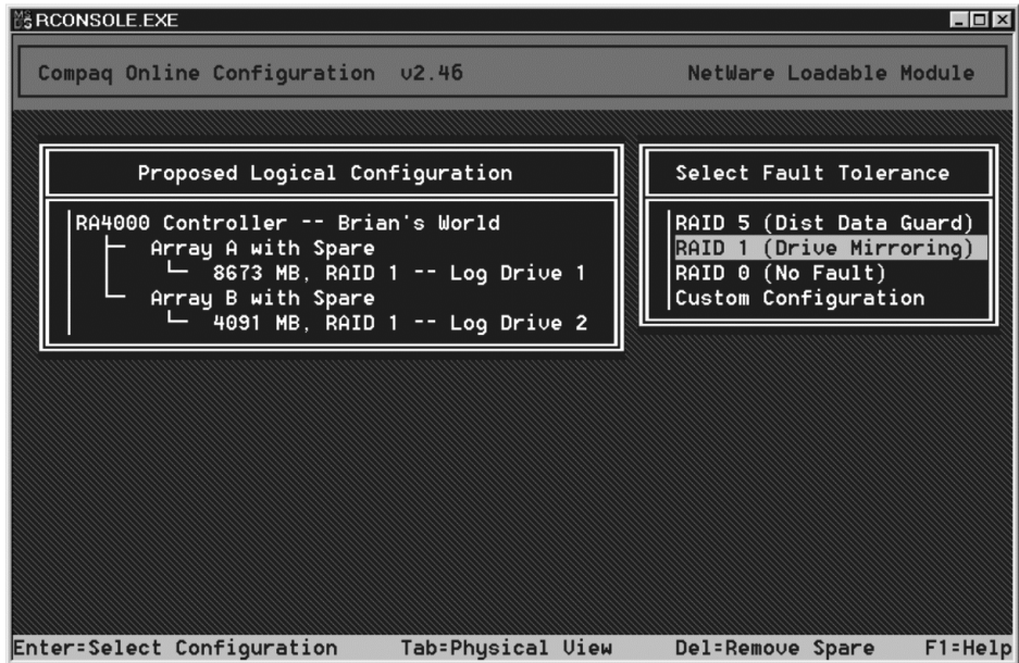
Afbeelding 5-29. Wizard voor automatisch configureren bij geselecteerde RAID 1-fouttoleranties
