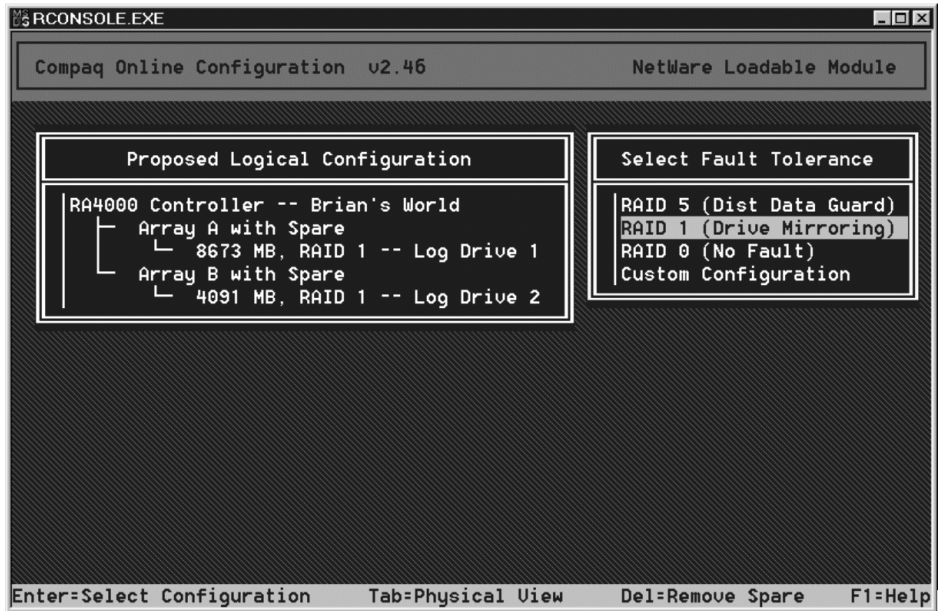
Figura 5-29. Configurazione automatica con tolleranza agli errori RAID 1 selezionata
