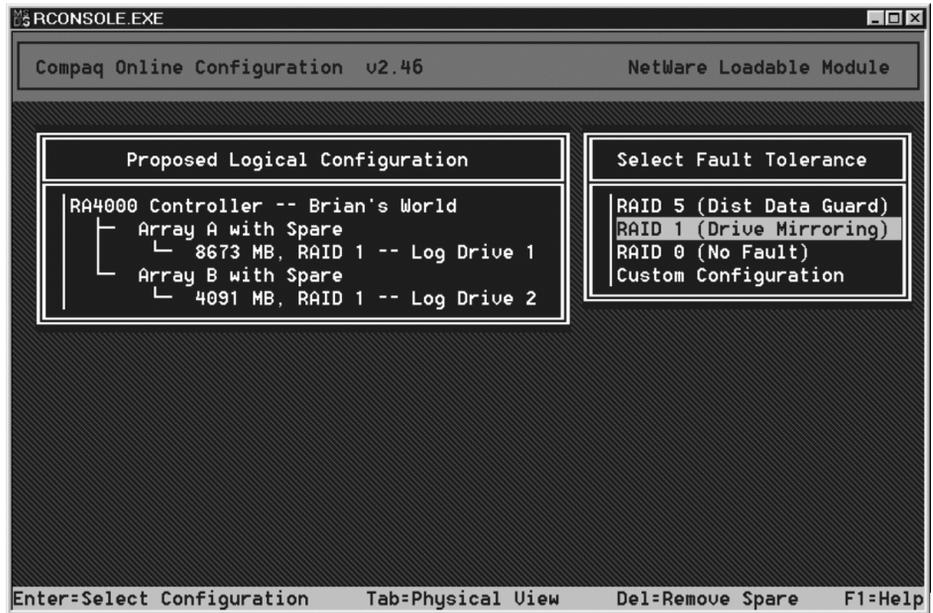
Figure 5-29. Assistant de configuration automatique avec la méthode de tolérance de pannes RAID 1 sélectionnée
