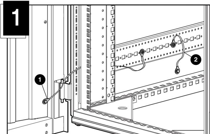
Entfernen sie die Schraube der vorderen Tür, stecken Sie darauf eine Zahnscheibe und befestigen Sie anschließend die Schraube wieder.
