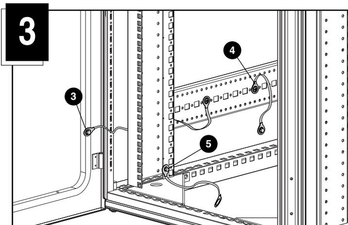
Von der 19-Zoll-Winkelschiene zur Oberseite des Racks und anschließend zur gelochten Abdeckung:
