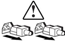
Diese Symbole an Netzteilen oder Stromversorgungssystemen weisen darauf hin, dass das Gerät über mehrere Stromquellen versorgt wird.
