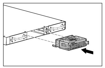
Figure 7-5: Installing a fan module
