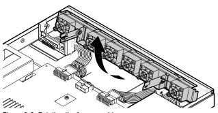
Figure 6-9. Rotating the fan assembly
