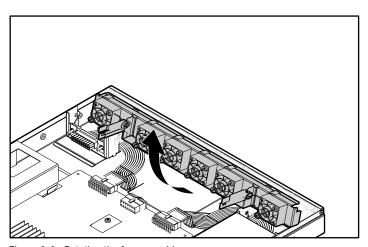
Figure 6-8. Rotating the fan assembly
