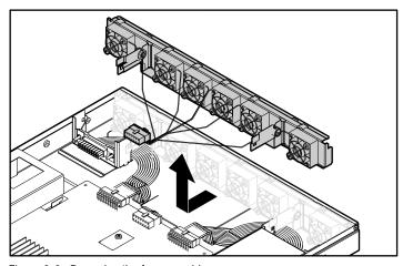
Figure 6-6. Removing the fan assembly
