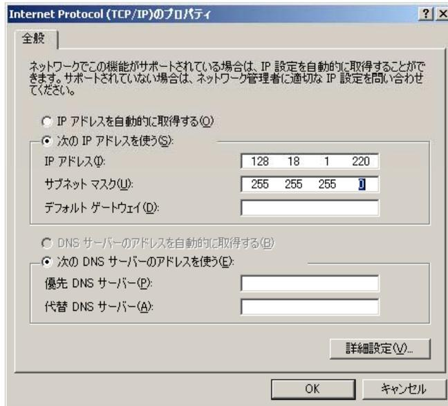
図2-9: NICチームのTCP/IPのプロパティ ダイアログ ボックス
