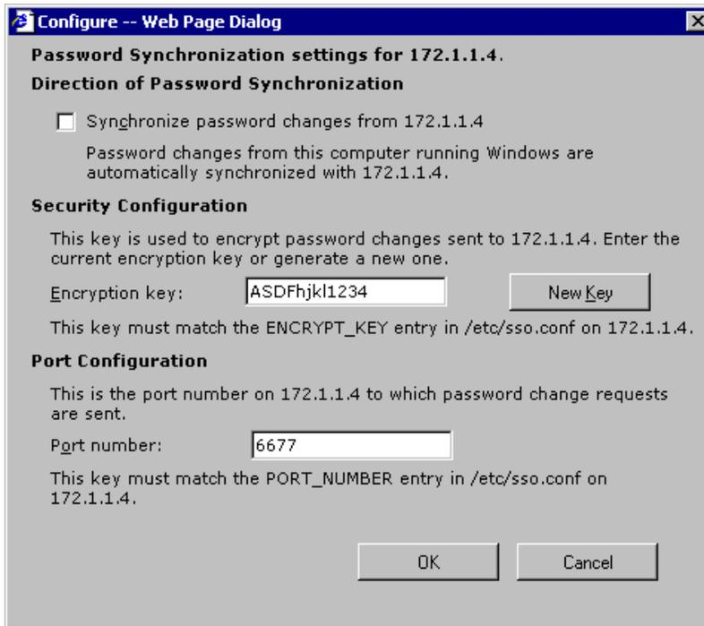
図9-20: [Password Synchronization]画面、[Advanced Settings]ダイアログ ボックス
