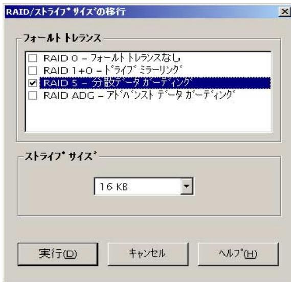
図5-13: [RAID/ストライプ サイズの移行]画面
