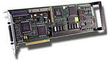
Con esta tarjeta se marca la introducción de la nueva tecnología Wide Ultra2 SCSI con una velocidad de transferencia de 80 MB/s, el doble de rápido que la tecnología Wide Ultra SCSI-3.
