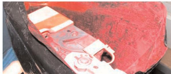
**Durante las pruebas el tóner magenta se derramó dentro de un sobre sellado de un cartucho remanufacturado.**
