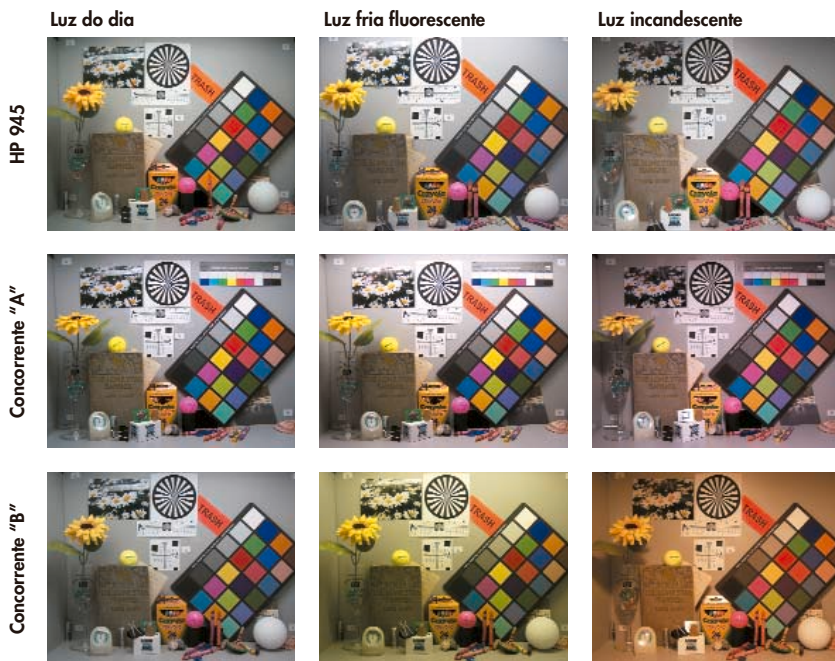
Estas fotos foram batidas em uma cabine de iluminação Macbeth com diferentes iluminantes, mostrando os resultados das três câmeras – uma HP photosmart e duas renomadas concorrentes.
